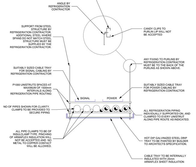
**7 REFRIGERATION PIPE SUPPORT WITH DRIP TRAY DETAIL**
